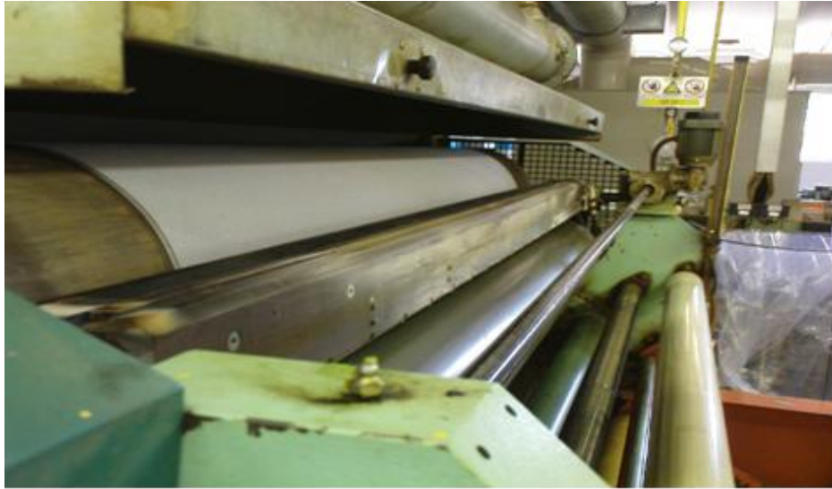
Slika 17: Očiščeni valji in gorilec
