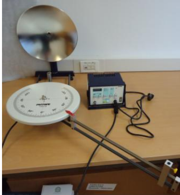
Slika 46: Goniometer z odbojnim zrcalom in operacijska enota goniometra.
