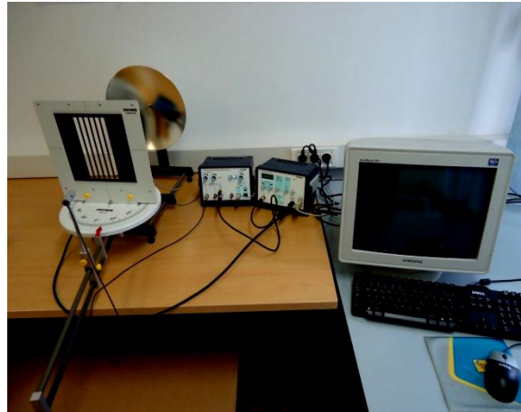
Slika 31: Fotografija eksperimenta za merjenje uklona ultrazvoka na režah.
