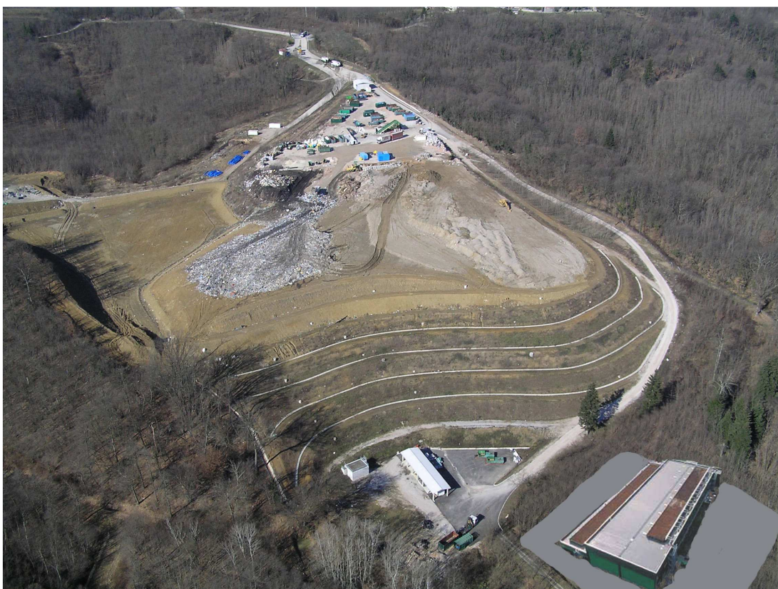
Slika 19: Center za ravnanje z odpadki Nova Gorica z izrisom bodočega objekta za mehansko biološko obdelavo odpadkov (Komunala Nova Gorica d.d., 2010)
