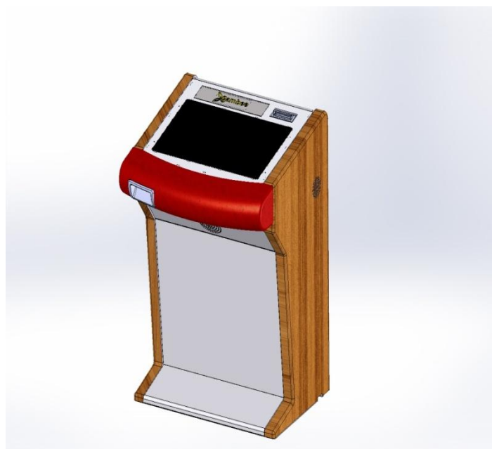
Slika 21: Prototip samostojnega igralnega mesta GP
