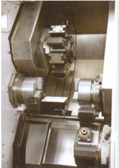
Slika 9: Notranjost dvovretenskega avtomatskega obdelovalnega stroja
