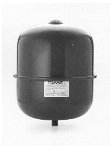
Slika 13: Primer zaprte ekspanzijske posode, s katero uravnavamo tlak vode v sistemu, do katerega pride zaradi temperaturnega raztezanja ali segrevanja
