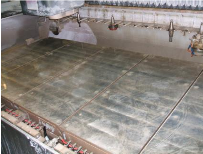
Slika 18: Porezkana obdelovalna miza
