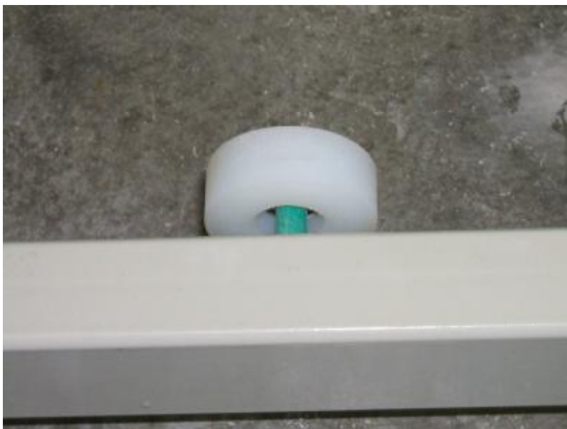
Slika 12: Kolesa, pritrjena na vodilo z vmesnim distančnikom
