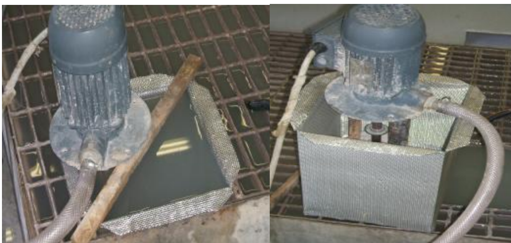
Slika 15: Končni izgled črpalke v zaščitni mreži
