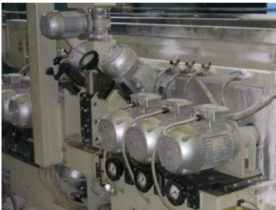
Slika 6-7: Cevi za dotok vode do brusnih kamnov in polirk
