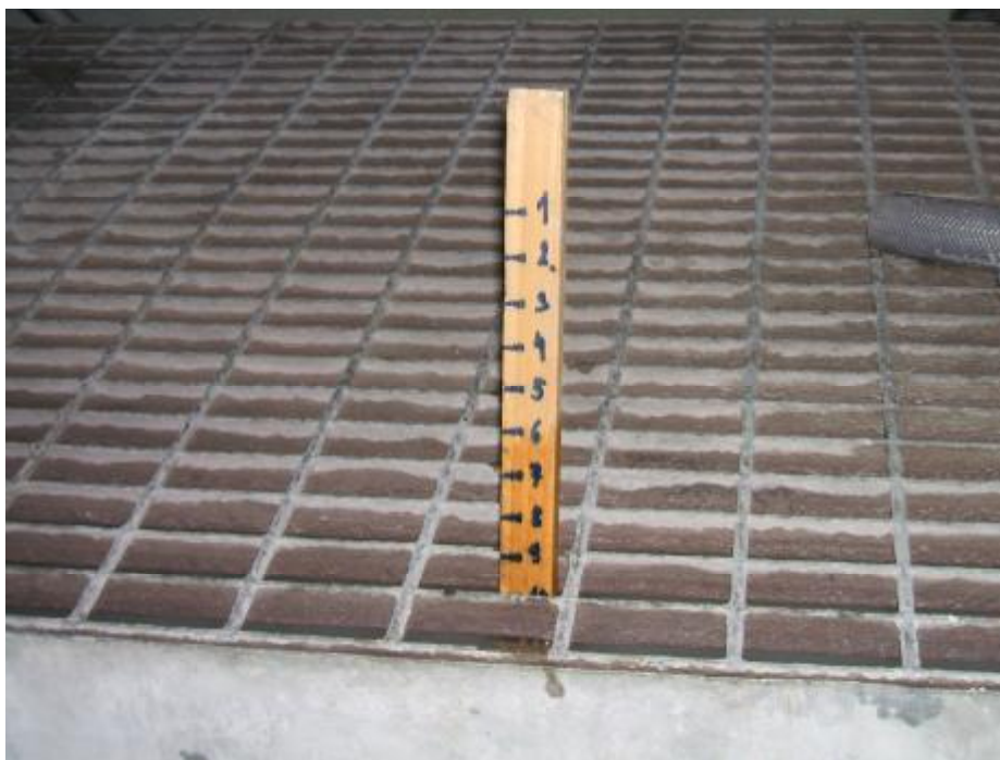
Slika 6-14: Številčnica, položena v zbiralni bazen, poln usedlin
