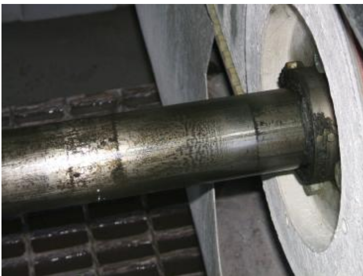
Slika 6-18: Dobro namazano vodilo (gred)
