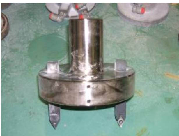
Slika 17: Orodje za rezkanje obdelovalne mize
