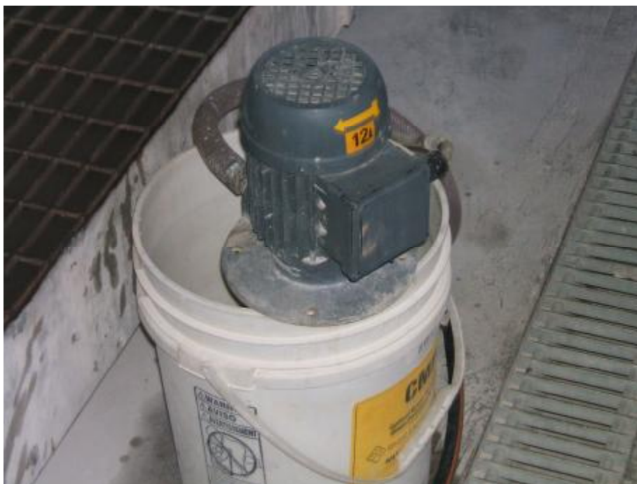
Slika 6-8: Črpalka v vedru z vodo za spiranje
