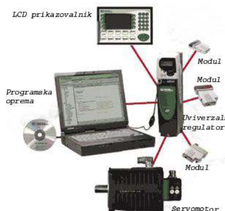
Slika 24: Sestavni elementi za programiranje in uporabo linije
