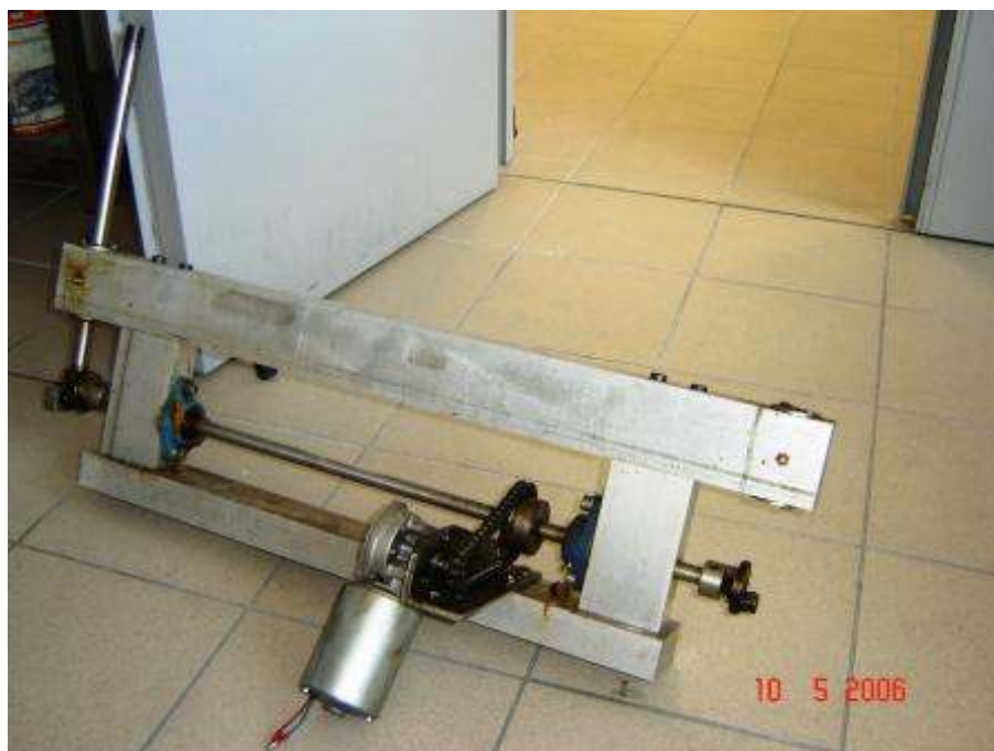
Slika 15: Konstrukcija pomika za namakanje leč
