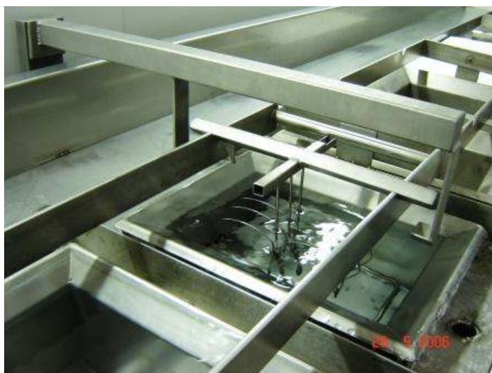
Slika 4: Prikaz pomične roke, ki dviga leče iz posode
