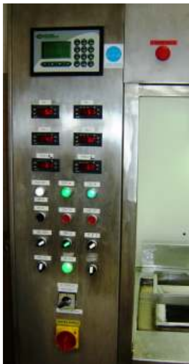
Slika 3: Prikaz osrednje konzole stroja (nastavitev temperatur tekočin)
