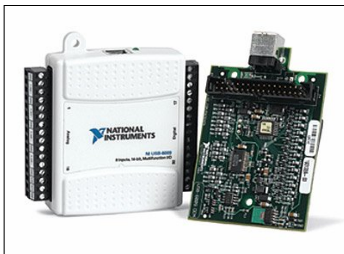
Slika 23: Pretvornik podjetja National Instruments, USB-6009 32 (Slika je uporabljena z dovoljenjem podjetja National Instruments Corporation)
