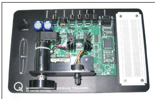
Slika 177: Modelna naprava enosmerni električni motor (Quanser DC motor control)
