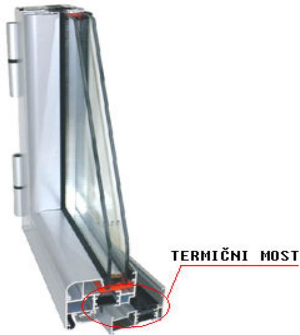
Slika 2: Termični most pri aluminijastih oknih (AluKomen, 2007)
