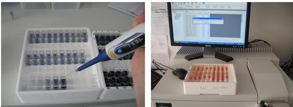
Slika 8: Postopek priprave vzorcev in analiza določanja skupnih fenolov s spektrofotometrično metodo (Foto: Karin Kurinčič, 2011)
