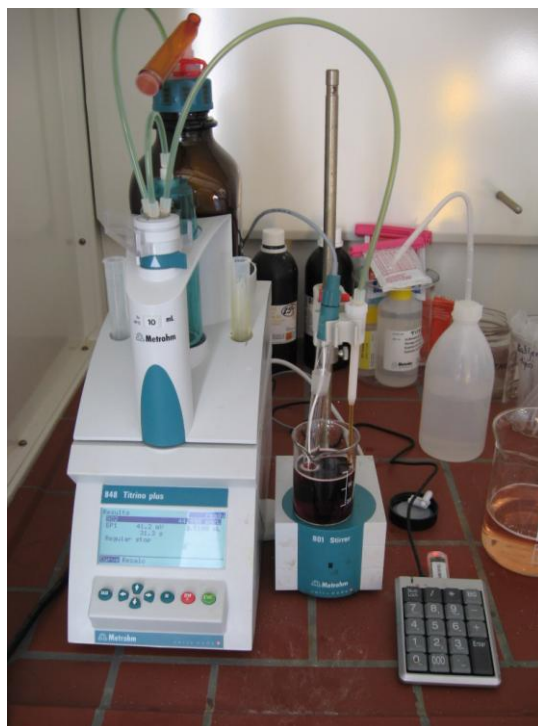
Slika 7: Določanje prostega SO_2 v vzorcih vina z avtomatskim titratorjem (Foto: Karin Kurinčič, 2011)
