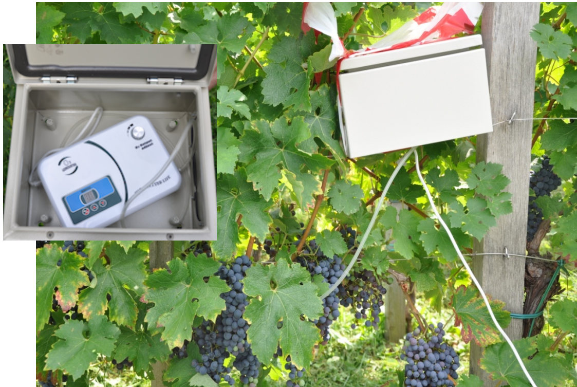
Slika 6: Tretiranje izbranih trsov s plinskim ozonom (Foto: Melita Sternad Lemut, 2010)
