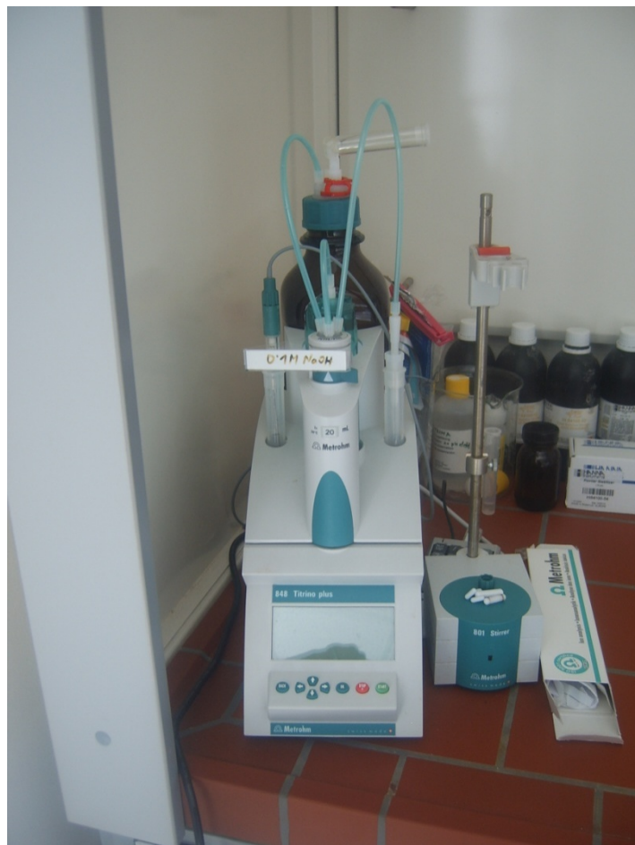
Slika 7: Avtomatski titrator s pH-elektrodo (Titrino 848 plus, Metrohm; Švica) (Foto: Rok Jež, 2012)
