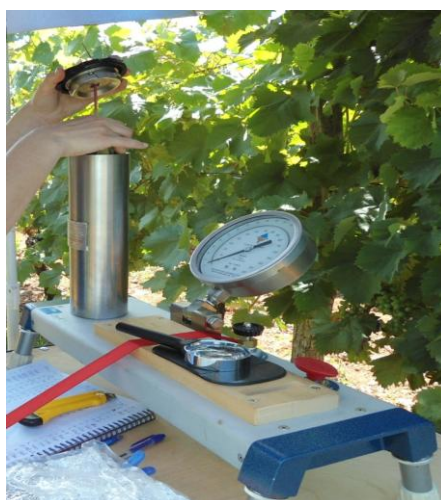
Slika 7: Schollanderjeva komora za merjenje vodnega potenciala rastline (Foto: Anastazija Jež, 2012)
