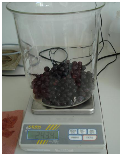
Slika 6: Tehtanje (določanje mase 100 jagod) s tehtnico KERN 440-47N (Foto: Irena Krajniger, 2012)
