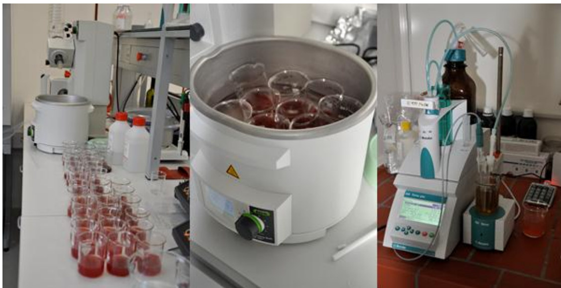
Slika 7: Priprava (rekonstrukcija) vzorcev s segrevanjem na 40 °C (Büchi R-210 rotavapor; Švica) (levo, sredina) in določanje vsebnosti skupnih titracijskih kislin (Titrimo 848 plus, Metrohm; Švica) (desno) (Foto: Irena Krajniger, 2012)
