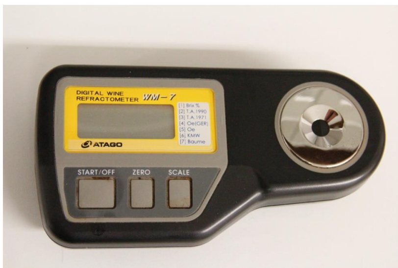
Slika 4: Refraktometer za določanje vsebnosti sladkorja (Foto: Matjaž Ščurek, 2013)
