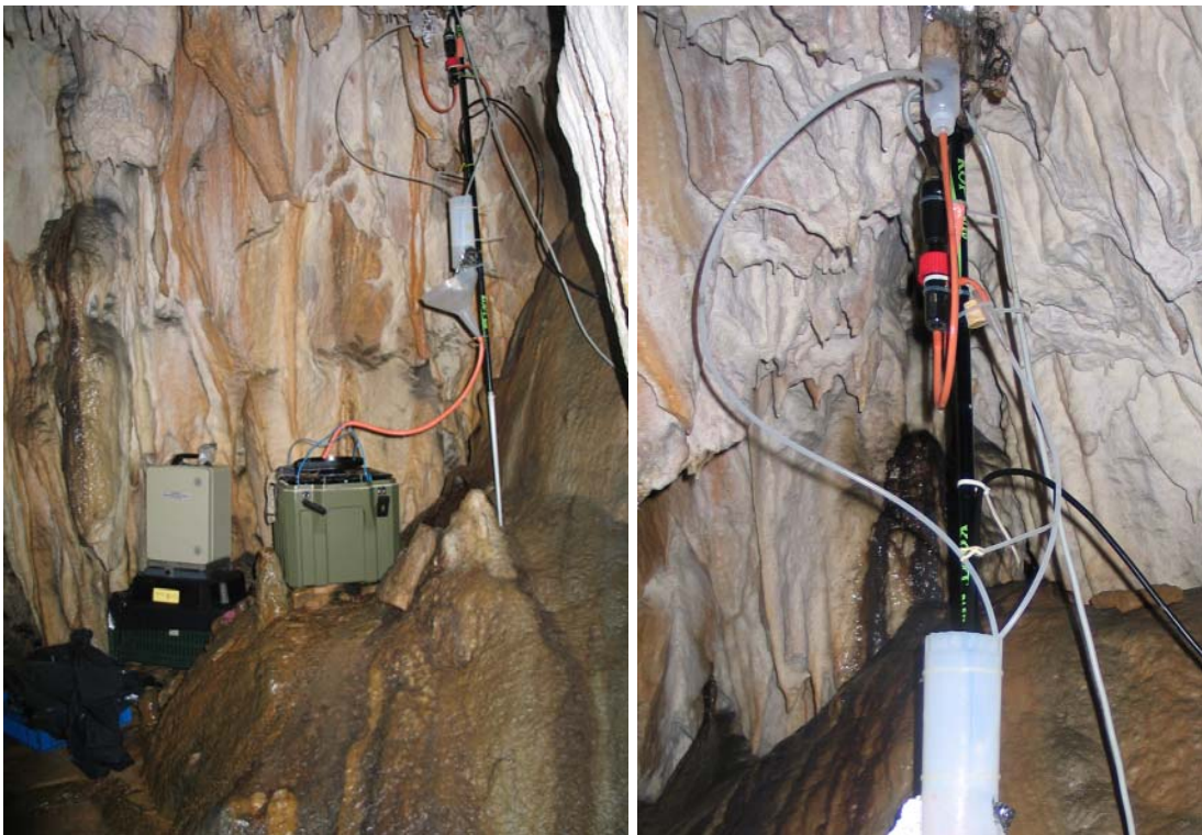
Slika 4.1.5: Meritve fizikalnih parametrov in vzorčenje curka J (levo). Detajl (desno) s posodico kamor doteka voda curka, ki nato protitočno teče v celico z WTW elektrodo za meritev temperature in SEP in odteka v posodo z iztokom, kjer je sonda, ki meri nivo za izračun pretokov. Ob visokih vodah odvajajo presežno vodo, ki ne more odtekati skozi omenjeni sistem, cevka neposredno v posodo, kjer se meri nivo.
