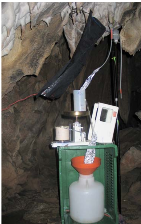
Slika 4.1.7: Meritve pretoka curka oz. kapljanja L. Voda kapljanja priteka v natego na evaporimetru. Ko se natega napolni, voda odteče v spodnjo zbirno posodo. Na papirnem registratorju se zabeleži hitrost polnjenja natege in iztok vode.
