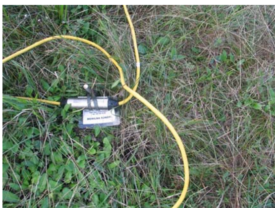
Slika 4.1.12: Sonde smo zabili v tla, kjer so ostale ves čas meritev.
