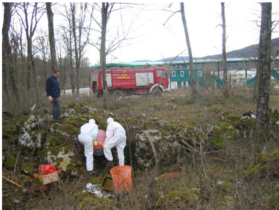
Slika 5.7.12: Injicirano sledilo (injiciranje je trajalo 15 minut) smo sprali s cisterno vode ( 5\text{ m}^3 ) v času nekaj ur, ker je bila požiralnost sorazmerno slaba.
