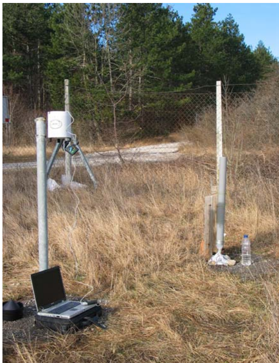
Slika 4.1.1: Meritve padavin in zajem vzorcev padavin za izotopske analize ^{18}\text{O} so potekale v ograjenem delu vojašnice Slovenske vojske v Postojni.
