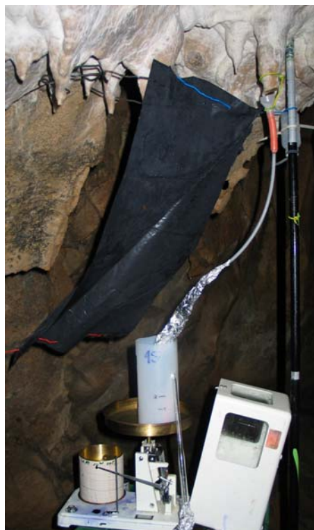
Slika 4.1.7: Meritve pretoka curka oz. kapljanja L. Voda kapljanja priteka v natego na evaporimetru. Ko se natega napolni, voda odteče v spodnjo zbirno posodo. Na papirnem registratorju se zabeleži hitrost polnjenja natege in iztok vode.
