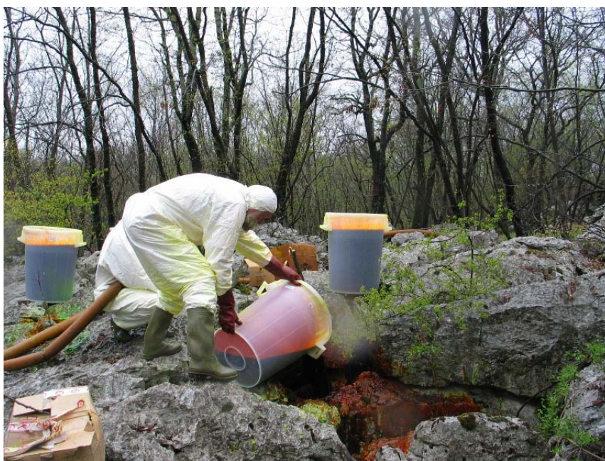
Slika 5.7.5: Injiciranje fluorescentnega sledila uranin po škrapljišču ob robu sežanskega odlagališča odpadkov.
