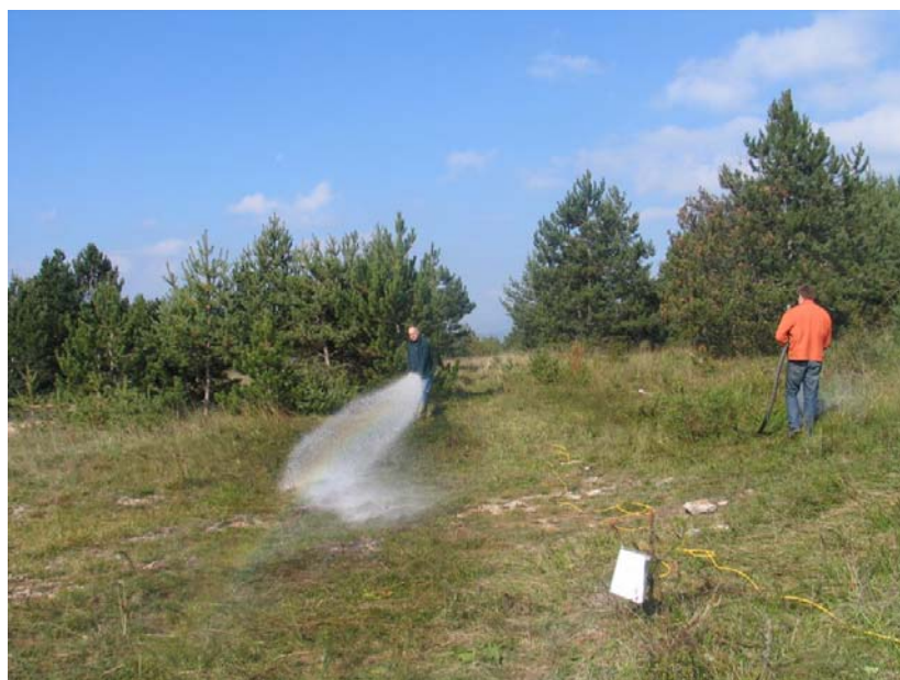
Slika 5.9.4: Simuliranje dežja v poskusu oktobra 2006 je potekalo po obeh straneh črte elektrod.
