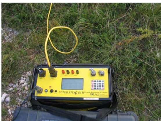
Slika 4.1.11: Za snemanje zgradbe zgornje vadozne cone smo uporabili sistem SuperSting Rq/IP, proizvajalca Advanced Geoscience Inc.
