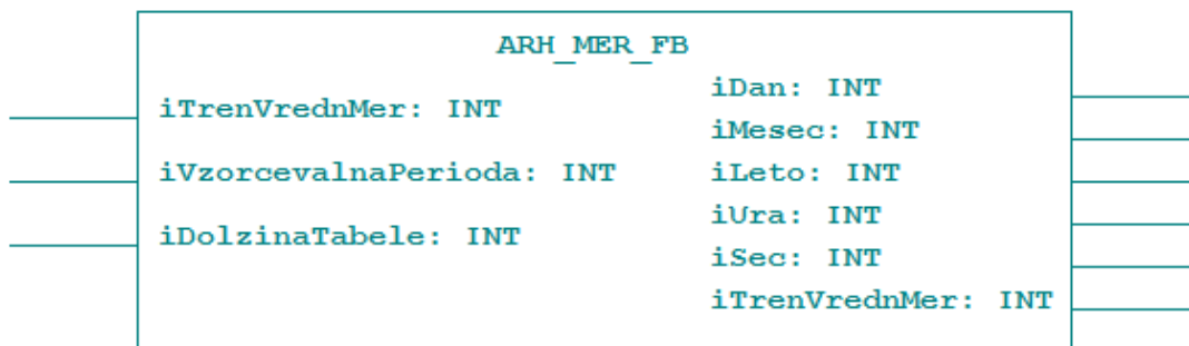
Slika 32: Funkcijski blok za vzorčenje meritev
