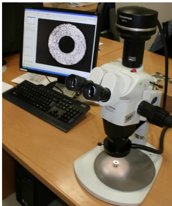
Slika 12: Uporabljena oprema za zajem slik grafitnih polizdelkov
