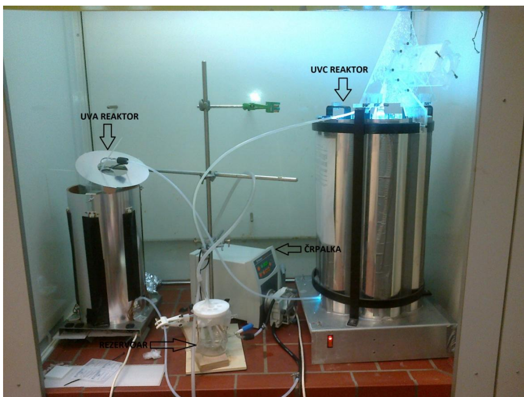
Slika 3: Laboratorijski reaktorski sistem, ki sem ga uporabljal pri poskusih zniževanja TOC z različnimi NOM
