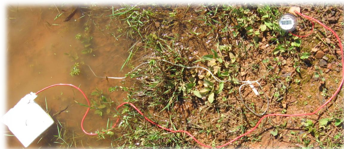
Slika 2: Delovanje digitalne ure z uporabo odkritega nizkoenergijskega vira v vodnem okolju (Luin, 2013)
