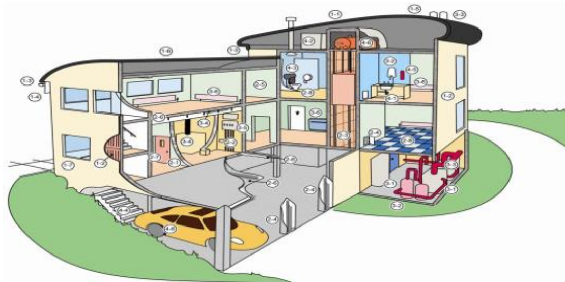
Slika 3: Azbestna zgradba, s prikazanimi običajnimi mesti materialov, ki vsebujejo azbest.
